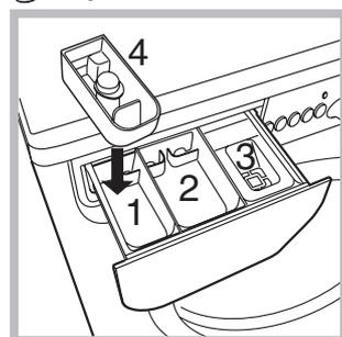
Funkcja ta przydatna jest w celu usuwania bardziej opornych plam. Wstawić dodatkowy pojemniczek 4, na wyposażeniu, do przegródki 1. Przy dozowaniu wybielacza nie przekroczyć poziomu „max” wskazanego na środkowej osce (patrz rysunek).
